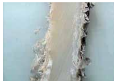
Sezione di una placchetta di Apinat Soft, con gli effetti della biodegradazione raggiunta sotto terra dopo tre mesi. A section through a piece of Apinat Soft, with the effects of biodegradation achieved after 3 months burial in earth.
