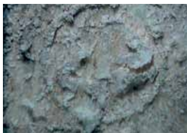
Immagine del logo API su una placchetta di Apinat Soft, con gli effetti della biodegradazione raggiunta sotto terra dopo tre mesi. The API logo on a piece of Apinat Soft, with the effects of biodegradation achieved after 3 months burial in earth.
